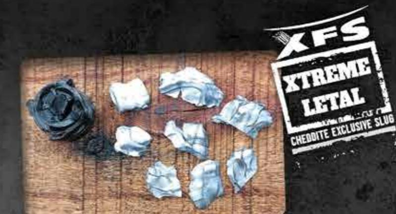
La frammentazione si genera SOLO all'interno della preda per effetto dello stop idrodinamico che avviene nei soli tessuti.
